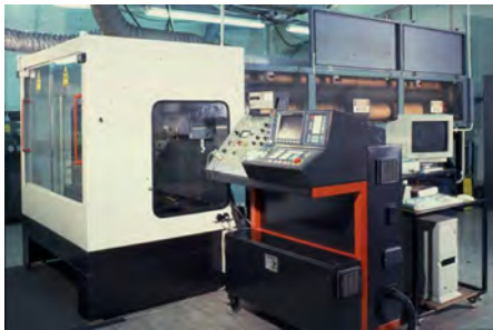
Opazovalna okna v zavarovanem območju laserja
